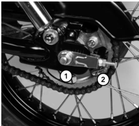
Se o valor for maior que o padrão, a corrente irá roçar no braço oscilante, fazendo barulho e provocando o seu desgaste o desgaste do pinhão e da coroa de transmissão. Em ambos os casos, o percurso da corrente deve ser reajustado.
