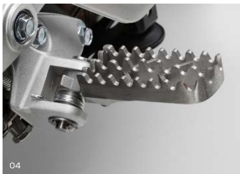
01 Pneus PIRELLI SCORPION RALLY 02 Protetor do cárter mais envolvente e em alumínio natural 03 Jantes de alumínio tubeless AKRONT com raios cruzados 04 Pousa-pés com opção de borracha antivibrações removível
