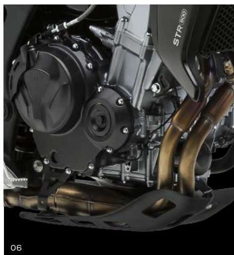
05 Pneus PIRELLI MT60 06 Protetor do cárter em alumínio pintado a preto 07 Jantes de liga tubeless de alumínio 08 Pousa-pés com borracha antivibrações removível
