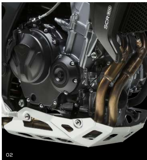
01 Pneus PIRELLI SCORPION RALLY 02 Protetor do cárter mais envolvente e em alumínio natural 03 Jantes de alumínio tubeless AKRONT com raios cruzados 04 Pousa-pés com opção de borracha antivibrações removível
