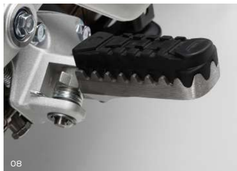
05 Pneus PIRELLI MT60 06 Protetor do cárter em alumínio pintado a preto 07 Jantes de liga tubeless de alumínio 08 Pousa-pés com borracha antivibrações removível
